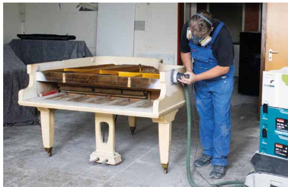
Im Rahmen der Restaurierung wird zunächst die alte Beschichtung des Klaviers abgeschliffen.
