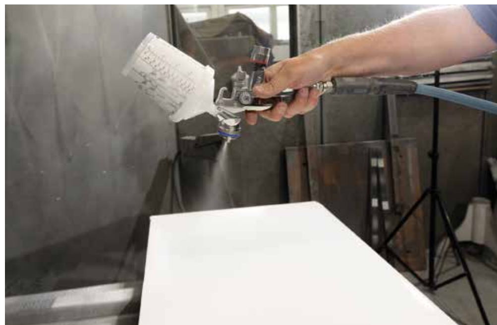
Vorbereitung der Oberfläche des Flügels mit Remmers Aqua PF-430-Pigmentfüller [iac].
